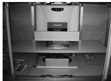
図 5 XGT本体にセットした検体
