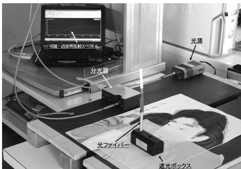
図3 可視-近赤外反射スペクトル測定装置
