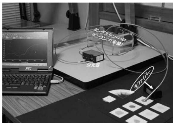
図6 可視-近赤外反射スペクトル非破壊分析装置
