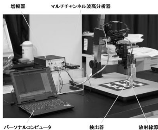
図4 低レベル放射性同位体 (RI) を用いる蛍光 X線非破壊分析装置
