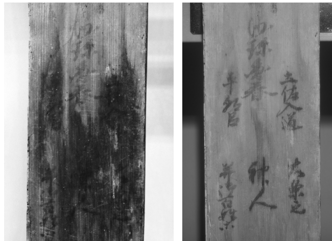
図2 永享十二年棟札の汚れのある部分の可視光線画像（左）と赤外線画像（右）
