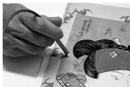
Fig. 8 Vis-Nir 反射スペクトル分析法における光ファイバーの先端
