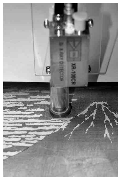
Fig. 2 RI 蛍光X線分析法における非接触線源
