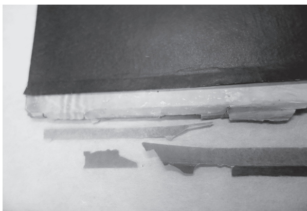
図版3 ホルダーの損傷状態2
