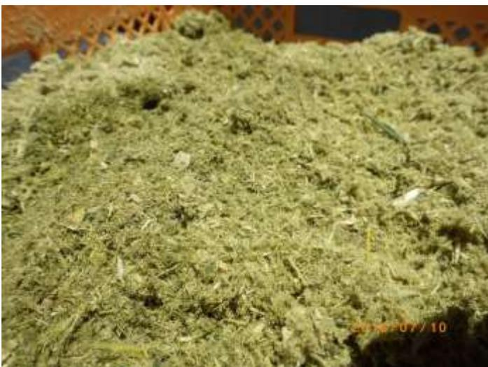
写真4 植繊機を用いて膨潤処理を行った竹パウダー
