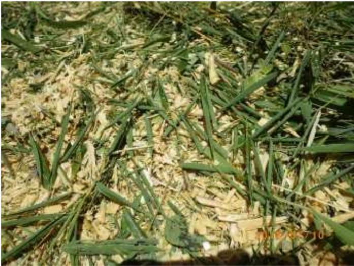
写真2 チッパーを用いて一次破碎を行った竹チップ
